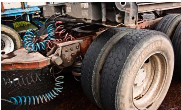
En la acción de frenado del remolque no interviene directamente el conductor, sino la barra de tracción del remolque. Si se frena el vehículo tractor, el remolque tiende a conservar la misma velocidad aproximándose hacia él, momento en que la barra de tracción actúa.
